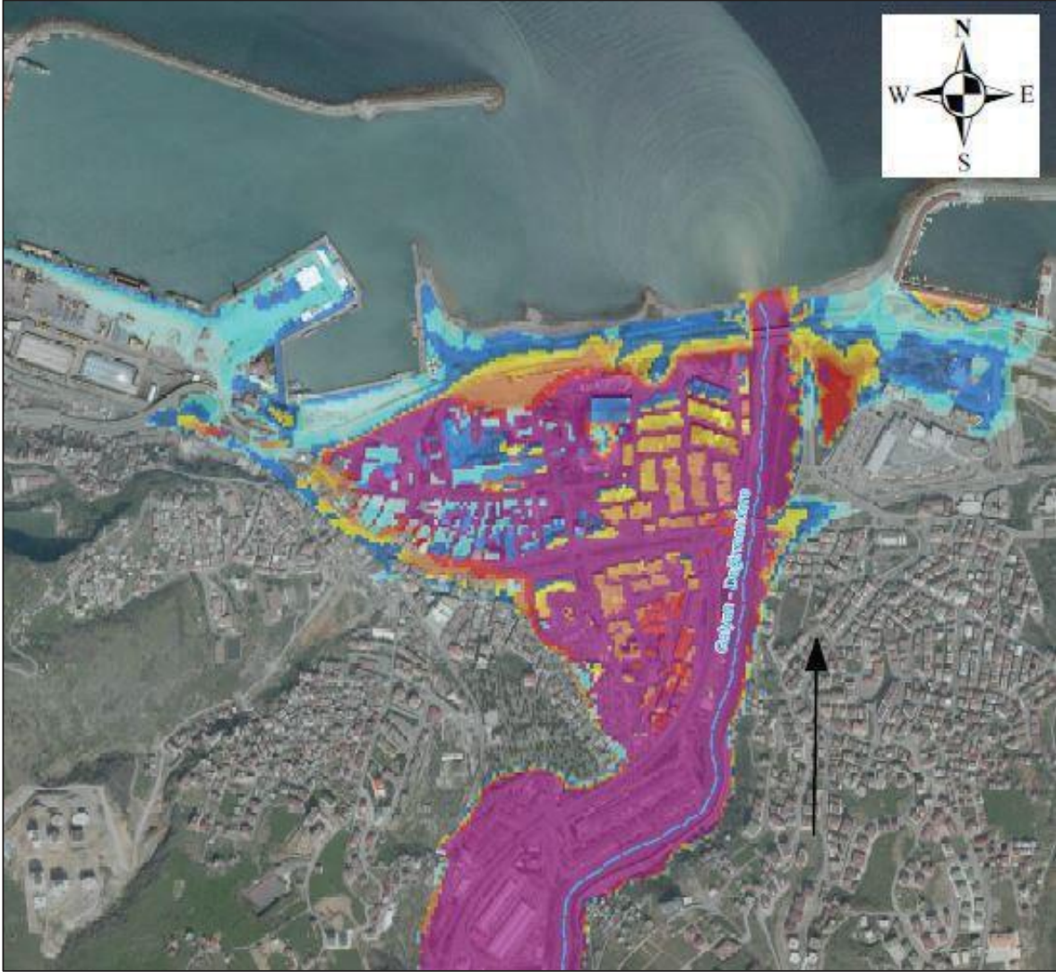
Şekil 2.61:Atasu Barajı Yıkılması Durumunda Taşkın Alanı Haritası. (DSİ 22. Bölge Müdürlüğü, 2021)
