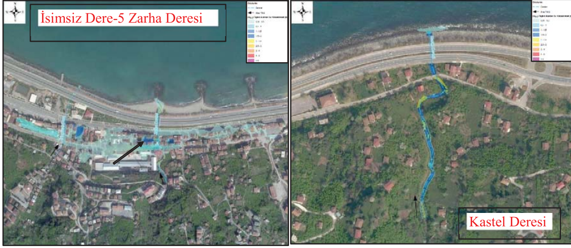
Şekil 2.51:İsimli Dere – 5- Zarha Deresi ve Kastel Deresi Risk Alanı Q1000 Taşkın Alanı Haritası. (DSİ 22. Bölge Müdürlüğü, 2021)
