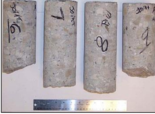
Şekil 5: Beton karot örnekleri.
