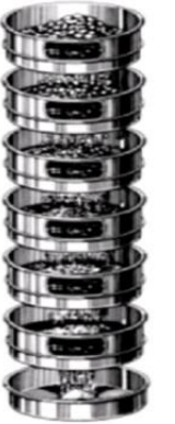
Şekil 1. Farklı boyut ve açıklığa sahip laboratuvar elekleri
