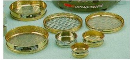
Şekil 1. Farklı boyut ve açıklığa sahip laboratuvar elekleri
