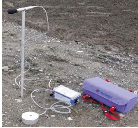
Şekil 2. InstanTEL Minimate Plus Model titreşim ölçer cihazı ve donanımı
