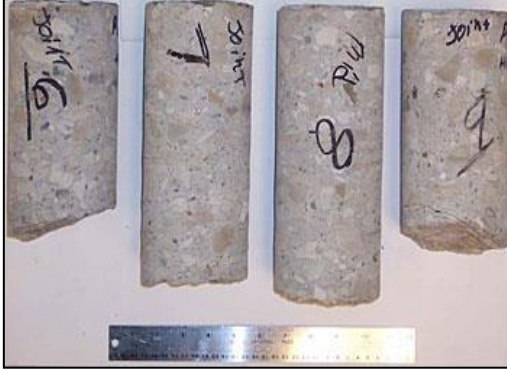
Şekil 5: Beton karot örnekleri.
