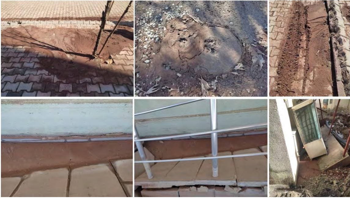
Şekil 55. Adıyaman Gölbaşı'nda sıvılaşma sonucu oluşan kum konileri
