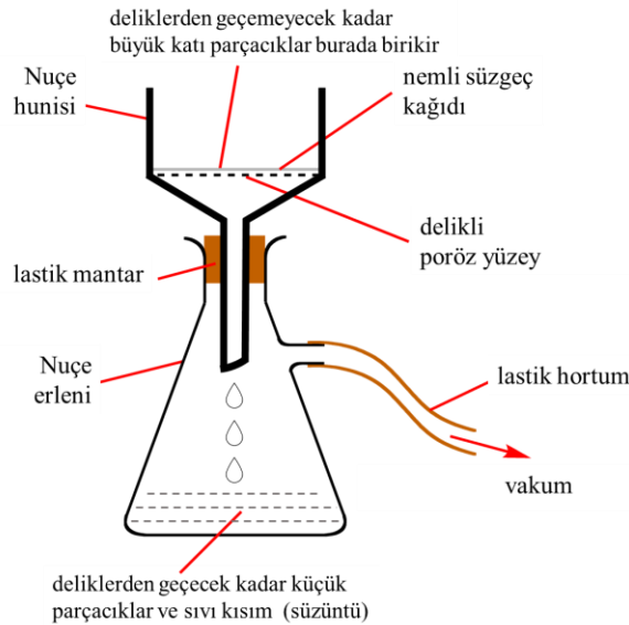
Şekil 1. Vakumla süzme düzeneği.
