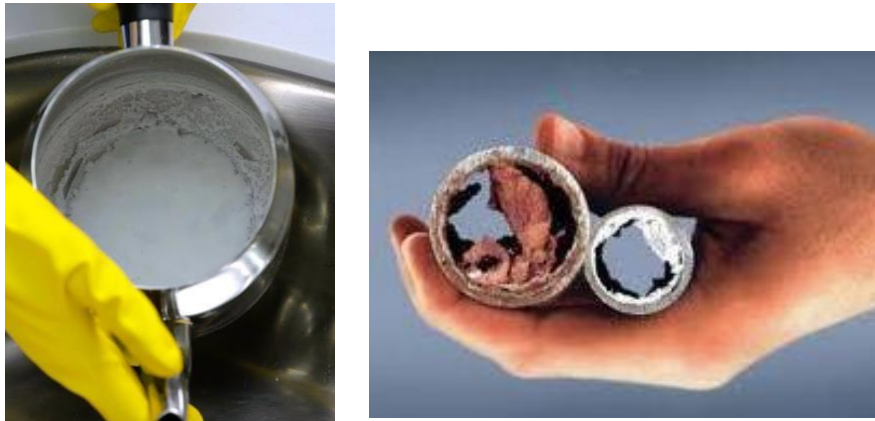
Şekil 1. Sert suyun çaydanlık ve borularda meydana getirdiği kireç (CaCO 3 ) tabakası
