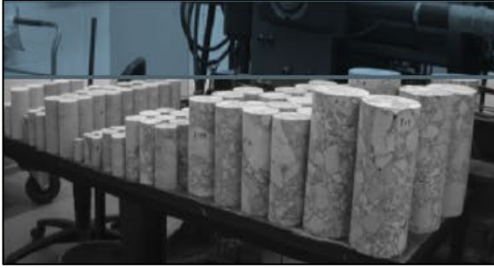
Şekil 1. Farklı boyutta karot örnekleri
