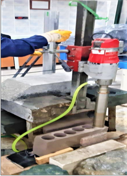
Şekil 2. Karot alma ve kesme cihazları
