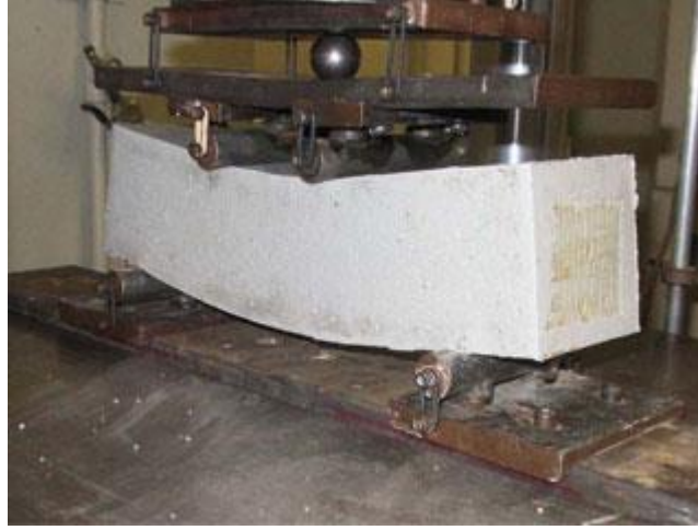
Şekil 7: Dört noktalı eğme deneyi
