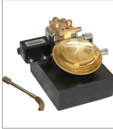
Şekil 2. Casagrande cihazı ve kanal açma aparatı
