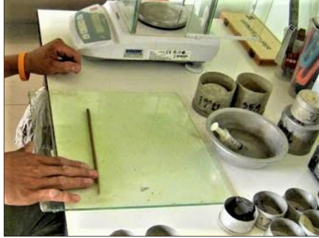
Şekil 9. Bir toprak numunesinin avuç içi ile yuvarlanması
