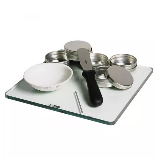
Şekil 8. Plastik limit test ekipmanları
