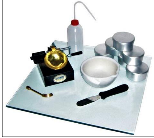
Şekil 3. Likit limit test ekipmanları
