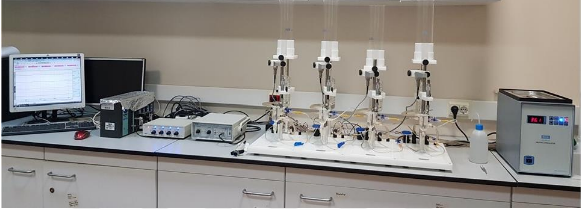
Resim 3. İzole organ banyo sistemi ve elektriksel alan stimülasyonu
