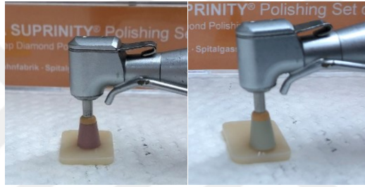
Resim 9. Vita Suprinity örneklerin mekanik polisajının yapılması
