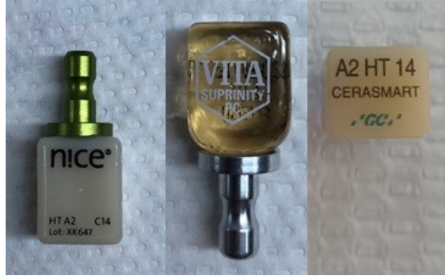
Resim 1. Çalışmada kullanılan Nice, Vita Suprinity ve Cerasmart blokları
