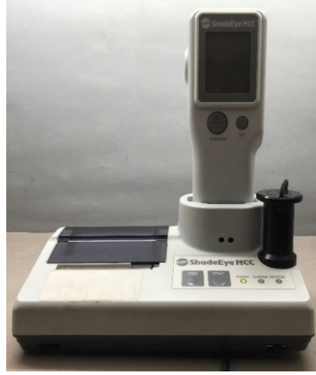
Resim 21. ShadeEye NCC kolorimetre cihazı
