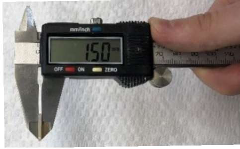
Resim 5. Örnek kalınlıklarının dijital kumpasla kontrol edilmesi.
