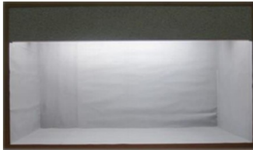
Resim 20. Ölçümlerde kullanılan nötral gri fonla kaplı renk ölçüm kutusu
