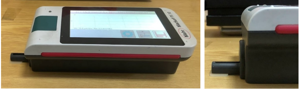
Resim 19. Kullanılan profilometre cihazı ve yüzey pürüzlülüğü ölçümü
