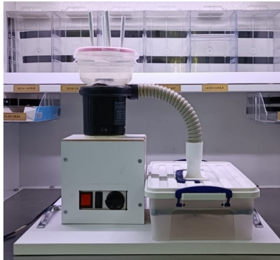
Resim 16. Hazırlanmış sigara düzeneği
