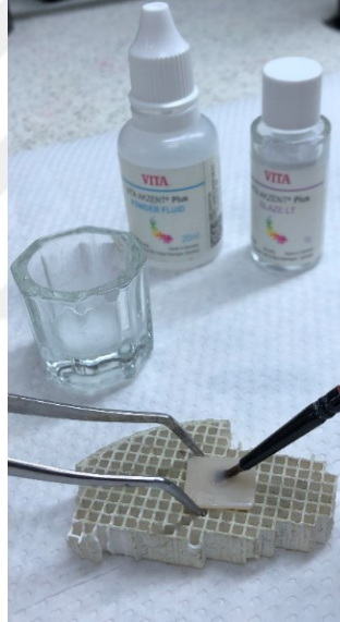
Resim 13. Nice seramiğin örnek yüzeylerine glaze uygulaması
