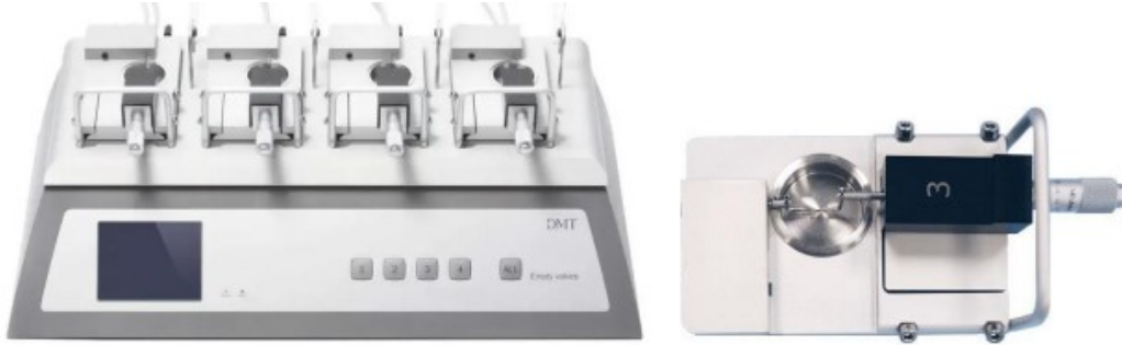
Resim 4. İzole organ banyosu deneylerinin yürütüldüğü miyograf cihazının temsili görüntüsü
