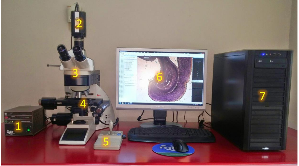
Resim 11. Stereoloji analiz sistemi: (1) mikrokator, (2) kamera, (3) mikroskop, (4) otomatik tabla, (5) el kumandası, (6) monitör, (7) bilgisayar kasası
