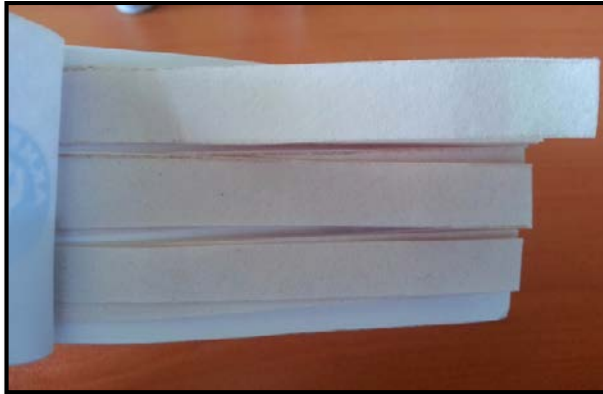
Resim 19. Üretilen pH kaęıtlarının strip formuna dönüştürölüdüęü hali
