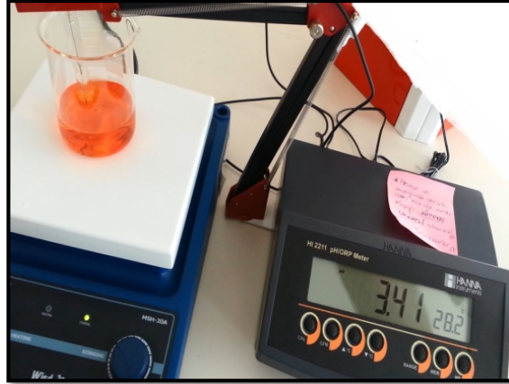
Resim 7. 1 M'lık NaOH damla damla eklendiğinde rengin dönmeye başladığı an
