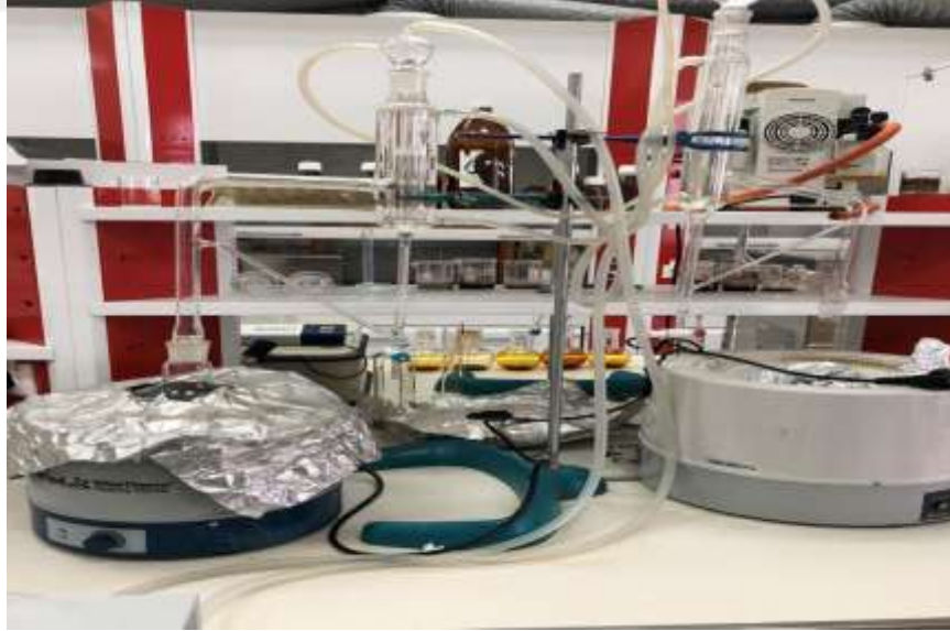
Resim 3. Uçucu yağ eldesinde kullanılan Clevanger düzeneği
