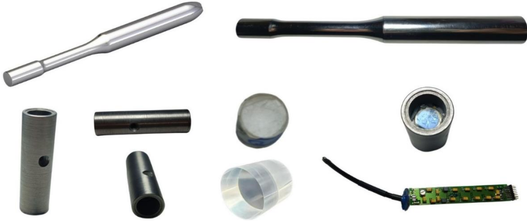
Şekil 12. Karadeniz Teknik Üniversitesi Nükleer Tıp Anabilim dalında kullanılan HiSens Gama probu ve içindeki temel parçalar (kolimatör, kristal, fotodiyot)
