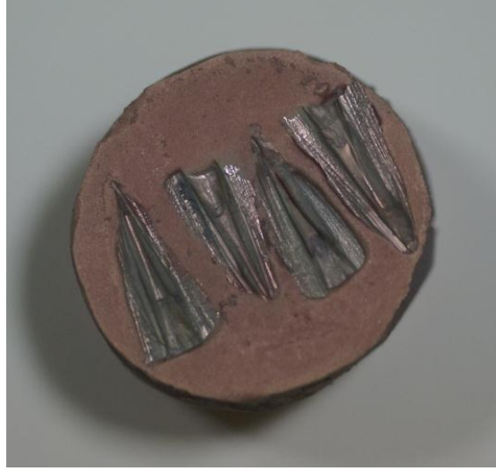
Resim 14. Altın/paladyum ile kaplanmış örneklerin görünümü
