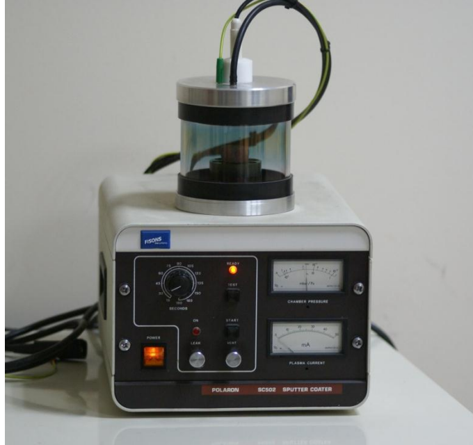
Resim 13. Örneklerin altın/paladyum ile kaplanması
