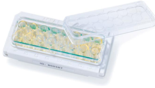
Resim 5. Altın mikroelektrotlar içeren 16 kuyucuklu E-pleyt
