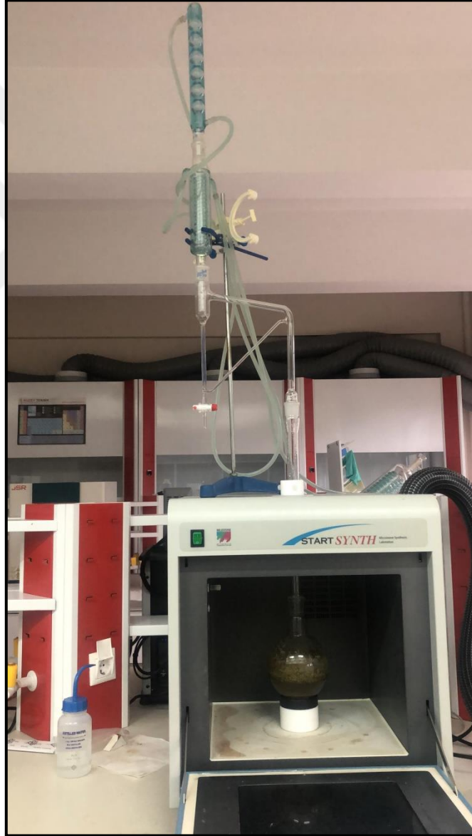
Resim 28. Mikrodalga fırın ile kombine Clevenger düzeneği
