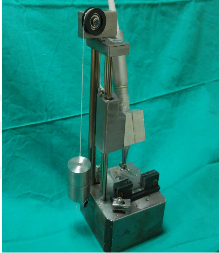
Resim 6. Kesme etkinliği test düzeneği
