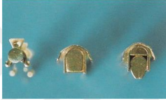
Şekil 8. Yuvarlak, Hader ve Dolder bar kesitleri (Schroder'den, 48)
