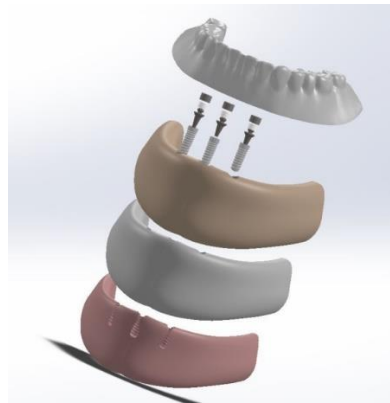
Şekil 20. Modellenen spongioz kemik, kortikal kemik, mukoza, implantlar, topuz başlı tutucu, naylon kep, metal kep ve protezin montaj görüntüsü
