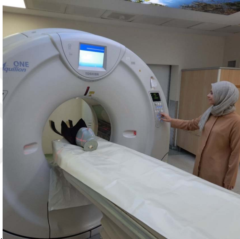
Şekil 21. Toshiba Aquilion One tomografi cihazında fantom materyali ile 80, 100, 120, 135 kVp potansiyel farklarda; 0.6, 1.3, 2.6, 6, 12, 24.2 mAs tüp akımı değerlerinde; SEMAR ve AIDR kapalı iken çekim süreci
